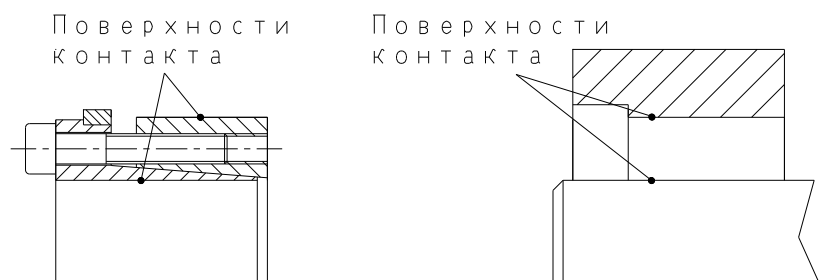
Рис. 6: Чистка поверхностей котакта (пример: CLAMPEX® KTR 201)
