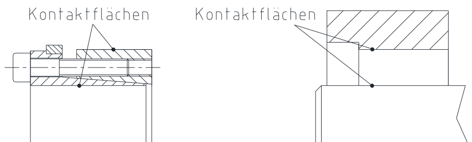
Bild 6: Reinigen der Kontaktflächen (Beispiel: CLAMPEX® KTR 201)
