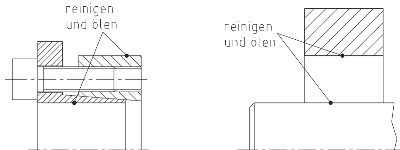
Bild 6: Reinigen und Ölen der Kontaktflächen (Beispiel: CLAMPEX® KTR 206)
