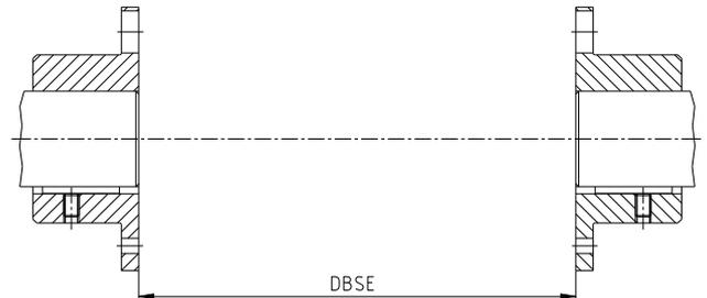
Bild 10: Ausrichtung auf das Maß DBSE
