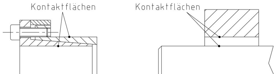
Bild 4: Reinigen der Kontaktflächen
