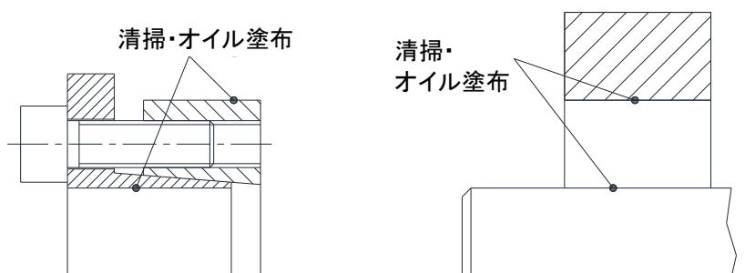
図 6: 清掃およびオイルを塗布する表面部分(例: CLAMPEX® KTR 206)
