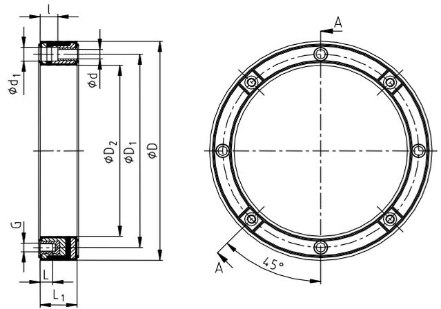
Bild 2: Dämpfungsring DT.../2
