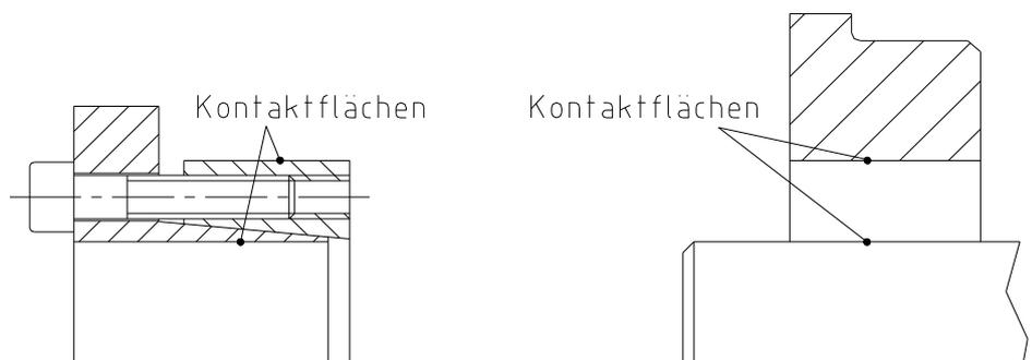
Bild 3: Reinigen der Kontaktflächen
