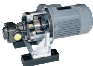
Adaptation d'une pompe à engrenage et d'un MINEX® SA 75/10 associé à une lanterne PK 200/30, une équerre-support et des patins amortisseurs
