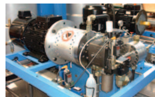
Étanchéité sans entretien de pompes de dosage de polyol et d'isocyanat pour machines à couler haute pression
