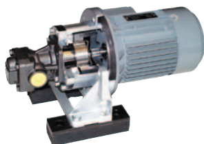
Hammaspyöräpumpun jälkivarustelu MINEX® SA 75/10 -kytkimellä, PK 200/30 -kytkinkotelolla, pohjalaipalla ja vaimennustangolla
