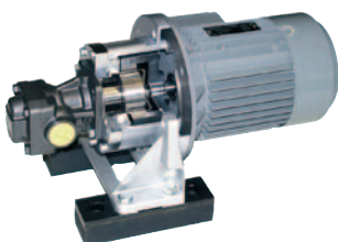
Nachrüstung einer Zahnradpumpe mit MINEX® SA 75/10, Pumpenträger PK 200/30, Fußflansch und Dämpfungsschiene
